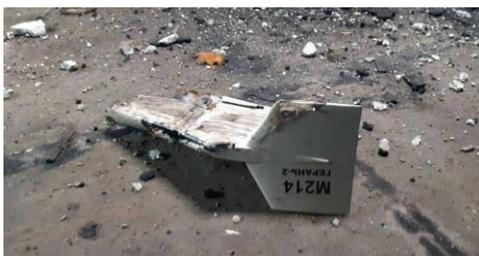
**Un débris de drone muni d'une aile delta Shahed-136.**
